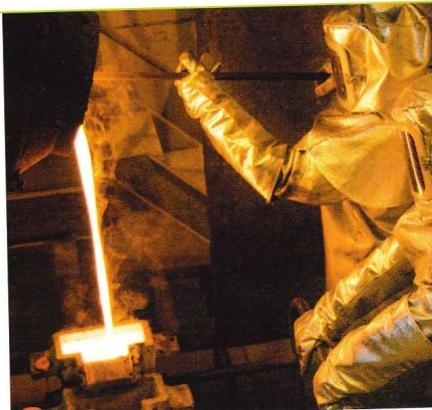
**2** Coulée d'aluminium liquide. L'aluminium passe à l'état liquide à 660 °C.
